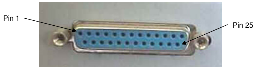
Figura 39: Layout di una porta parallela standard a 25 pins. Da in alto a sinistra: 1 - ... - 13 (fine del ramo superiore). Da in basso a sinistra: 14 - 15 - ... - 25.
